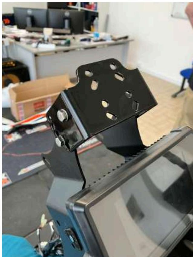
Raccordez les côtés au kit rally, en utilisant les écrous hexagonaux fournis dans le kit. Si les trous ne correspondent pas, c'est que le kit n'est pas parfaitement aligné. Dans ce cas, desserrez les vis du kit et ajustez sa position pour tout aligner.
