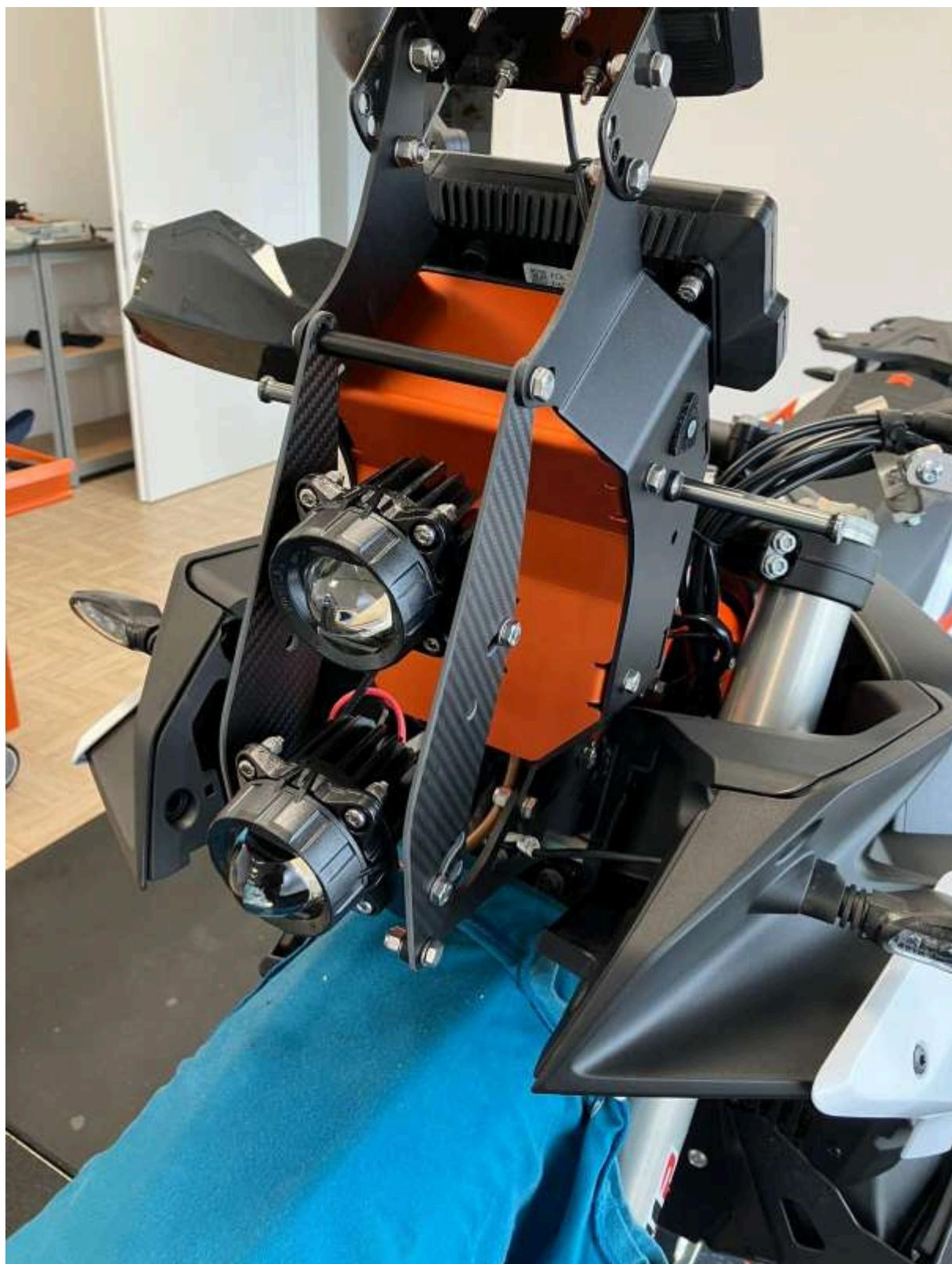
Installez les deux entretoises restantes sur les plaques carbone, puis installez les platines de fixation de la bulle, avec les rondelles larges.
