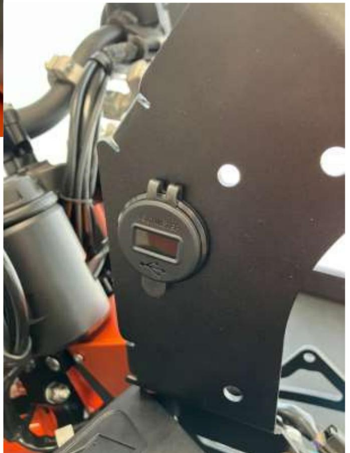
Préinstallez la platine support compteur fournie sur le compteur avec ses pattes d'adaptation.
