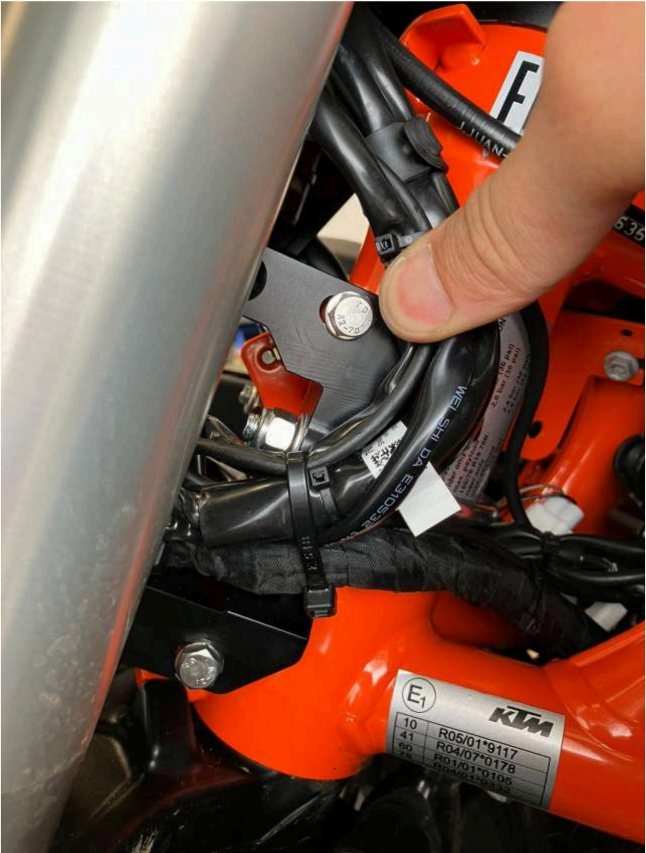
Terminez par la fixation de l'ensemble par la vis M5 fournie dans le kit.
