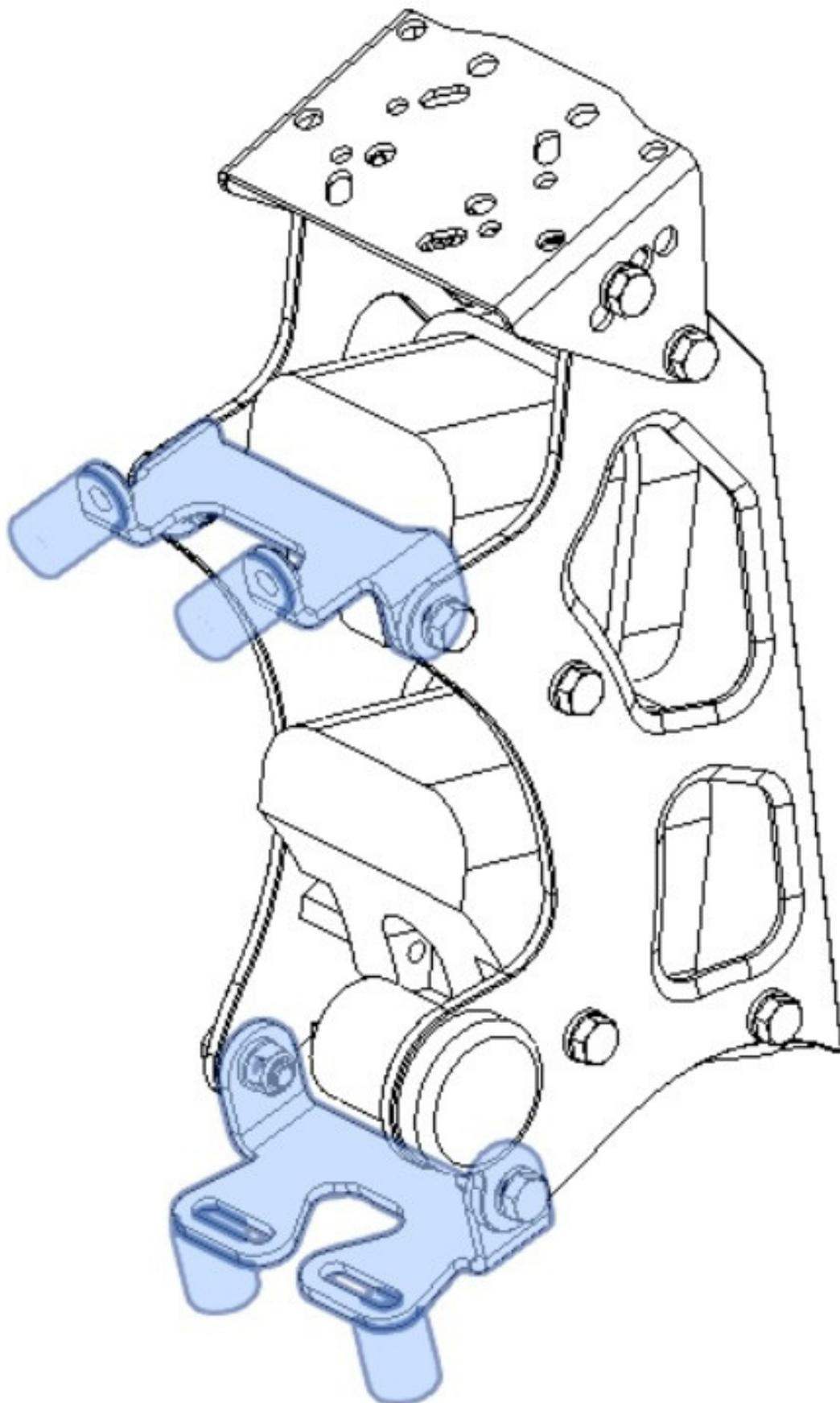
Pour tous nos modèles, nous fournissons le guide câble nécessaire pour le passage de la durit de frein. Il est nécessaire de l'installer pour éviter tout pincement. Le guide câble est imprimé en 3D, résistant au frottement sans causer de dommage à la durit. En cas de dommages causés au guide câble, il est possible de le commander en pièce détachée.
