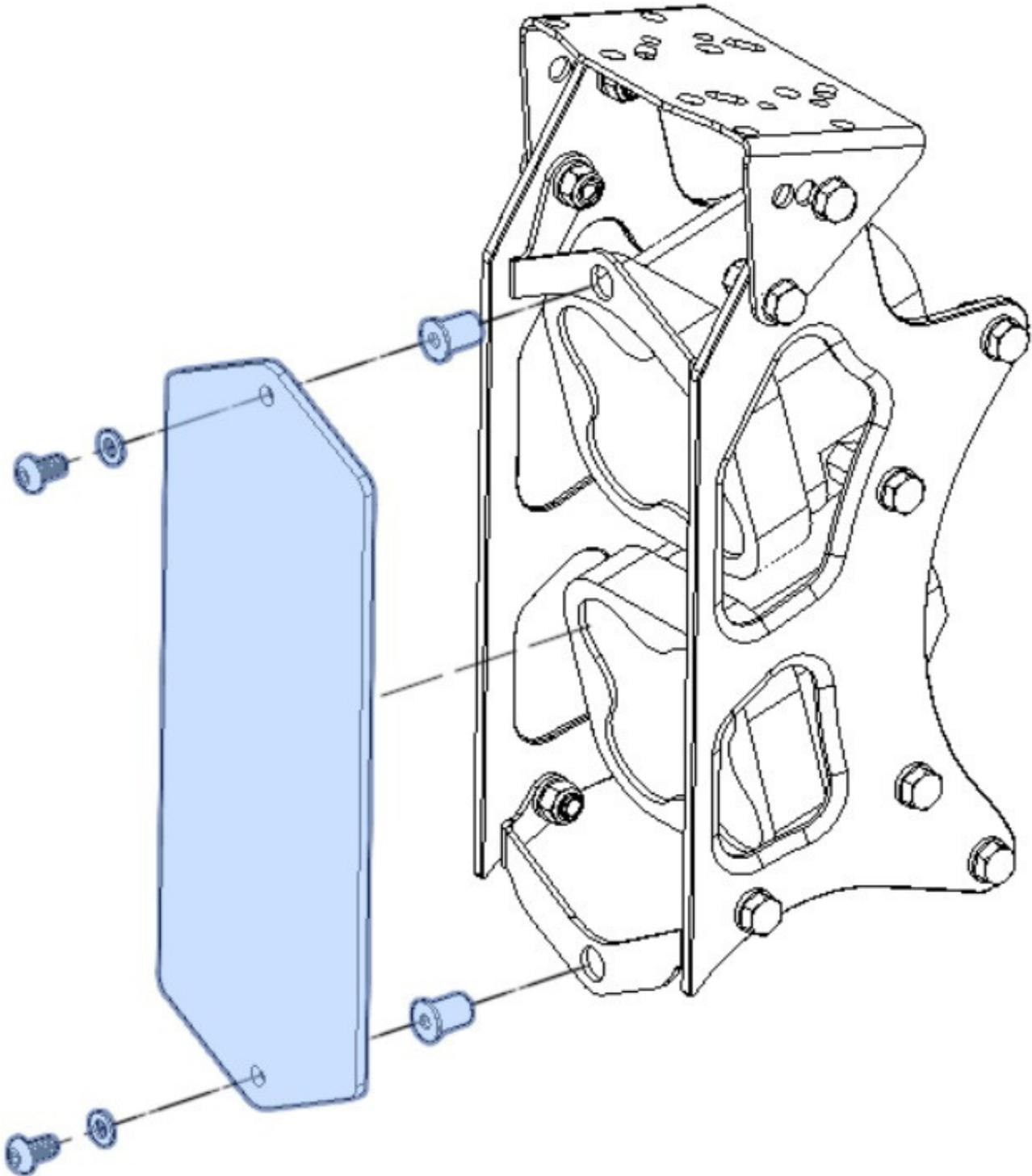
Nos kits se montent de manière plug & play sans aucune modification définitive de la moto, pouvant ainsi toujours revenir à la configuration d'origine. Pour la fixation, utilisez les trous existants sur les tés de fourche de la moto et les vis à tête creuse M6x25 fournies dans le kit. Dans certains cas, des entretoises ou des plaques sont fournies.
