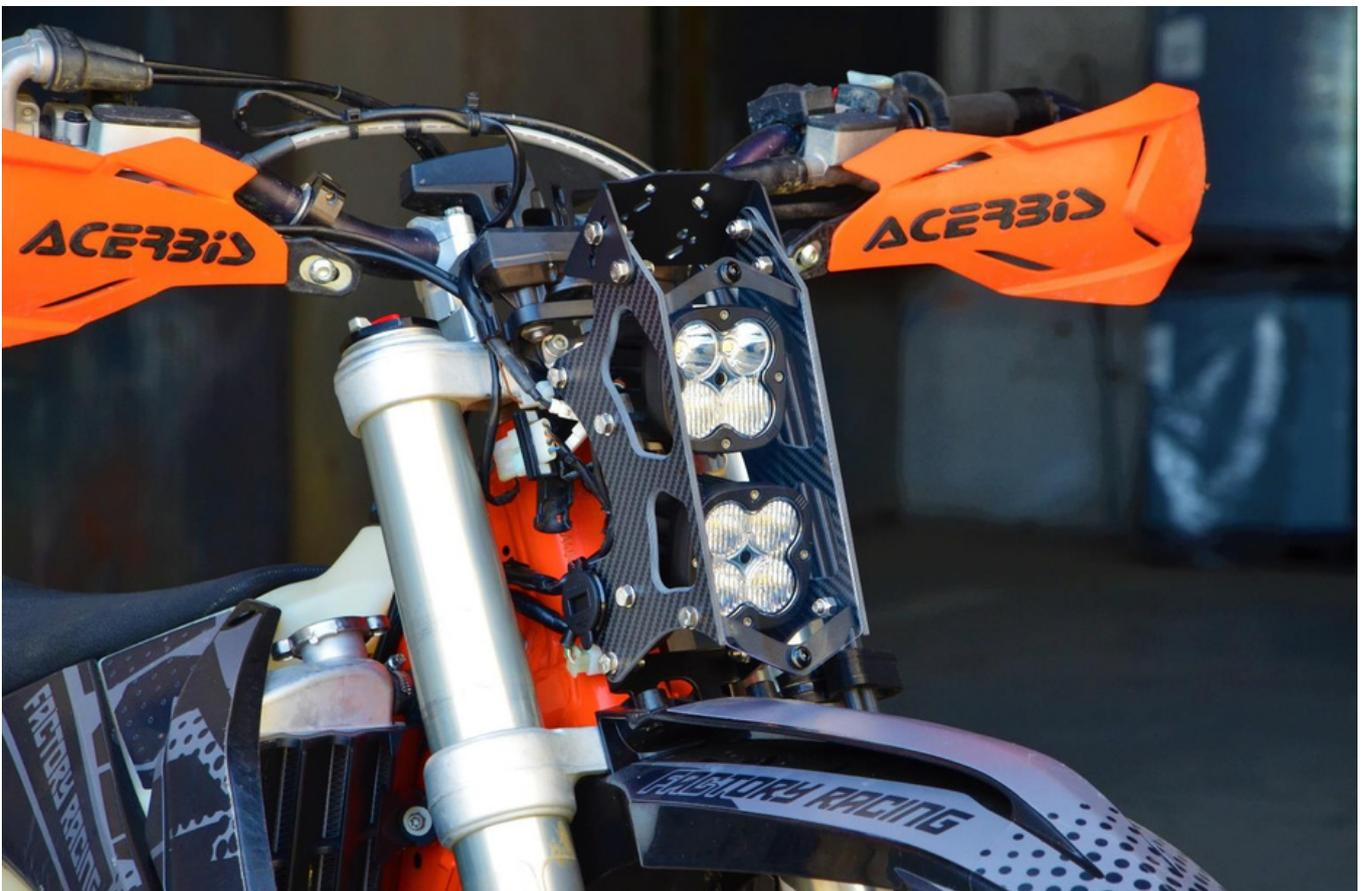
Assemblez les deux moitiés du kit et comme dans les images ci-dessous, en prenant soin d'assembler le feu de route (High beam) au-dessus, et le feu de croisement (Low beam) en dessous comme indiqué sur la page suivante.
