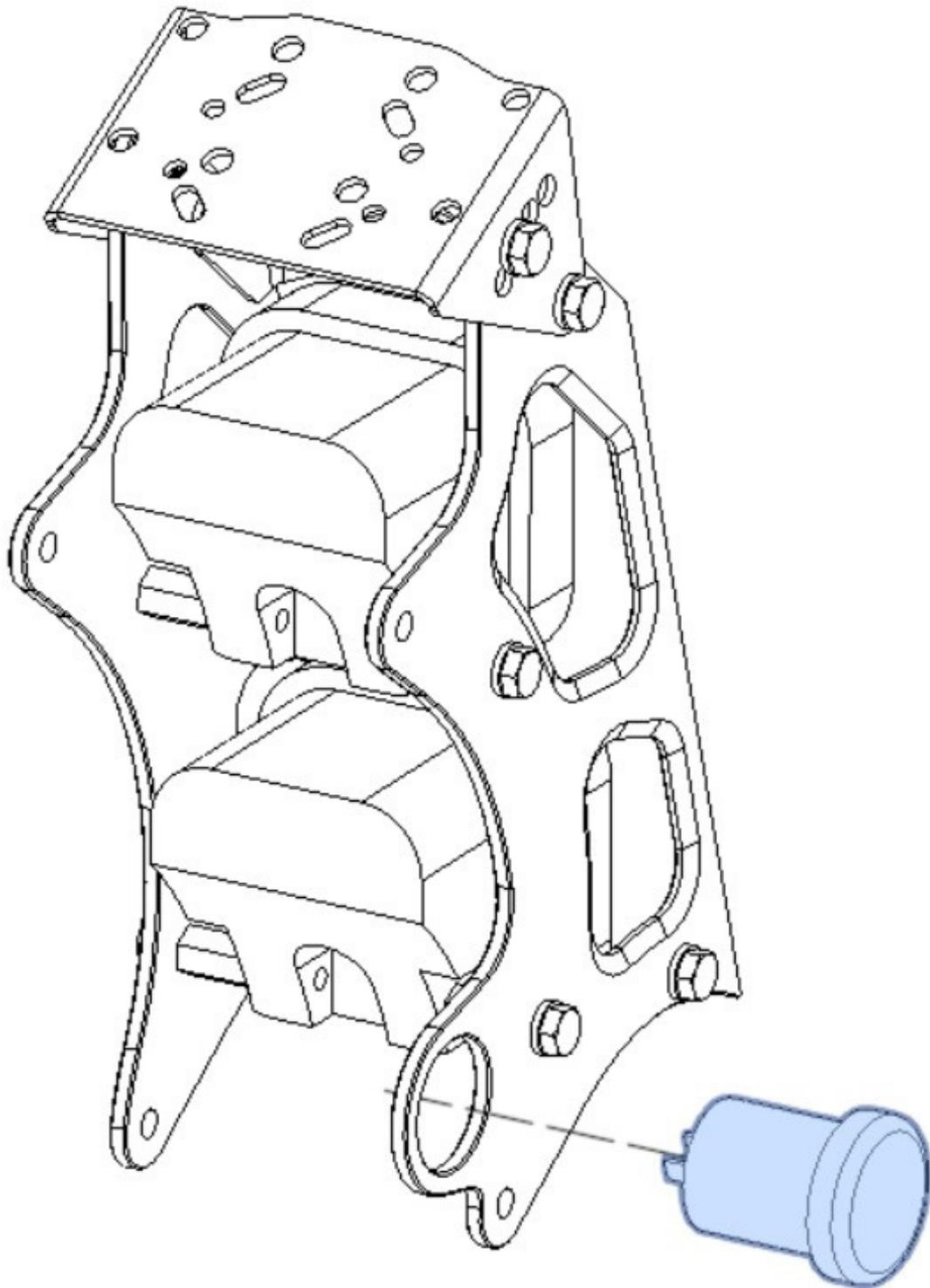
Assemblez la protection de phares avec les vis correspondantes et les inserts en caoutchouc fournis dans le kit.
