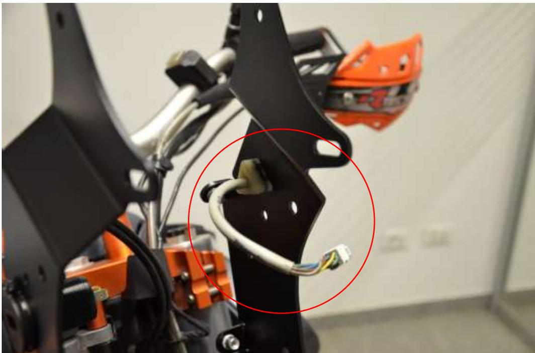
Démontez les caoutchoucs du tableau de bord d'origine et montez-les dans le support 4K dédié. Installez ensuite le compteur comme indiqué sur les photos. Ne serrez pas trop les écrous afin de ne pas endommager les filetages du compteur. Pour les modèles 950 / 990 avec l'ancien compteur, il est nécessaire de retirer le compte-tours. Pour les modèles 990 avec le nouveau compteur, suivez exactement la même procédure.
