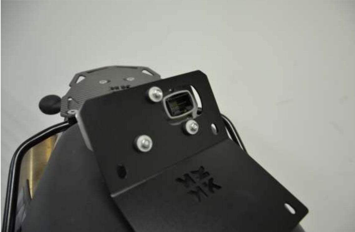
Assemblez le couvercle avec le compteur à la tour de navigation montée jusqu'à présent. Maintenant, l'opération importante avant de serrer toutes les vis est d'aligner les différentes plaques de manière à aligner précisément tous les bords. Procédez au serrage de toutes les vis M6 dès que l'alignement correct est obtenu, avec un couple de 12 Nm.
