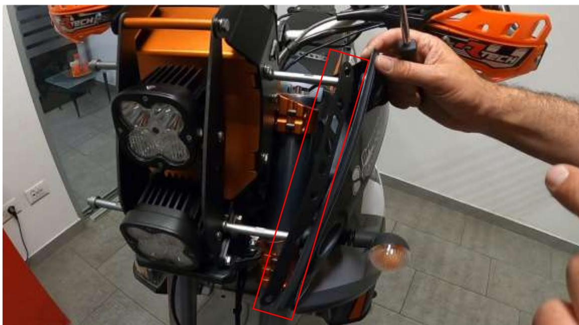
Placez le klaxon avec son support d'origine sur la vis de fixation du vase d'expansion, connectez les fils précédemment laissés hors de la chaussette et vérifiez qu'ils n'interfèrent pas avec le mouvement de la direction.
