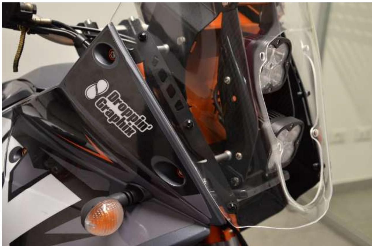
Maintenant, placez la bulle sur une surface douce (par exemple un chiffon roulé) et procédez à son perçage avec la perceuse.
