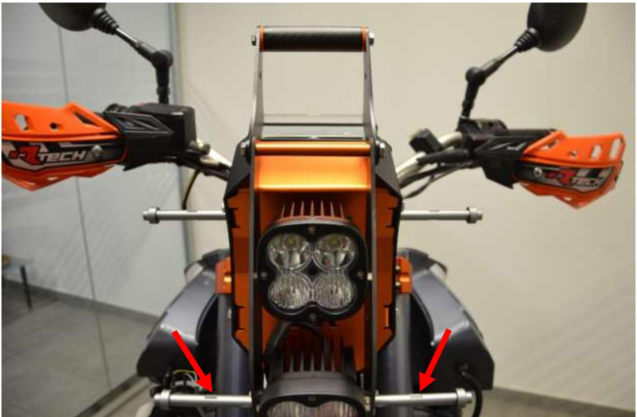
Placez les carénages latéraux et trouvez la position correcte des entretoises en les faisant glisser le long de la boucle. Effectuez un contrôle supplémentaire en montant également les supports de carénage pour vérifier que tout est aligné. Si nécessaire, le support en carbone a également des fentes sur la fixation supérieure, ce qui permet un ajustement supplémentaire. Ensuite, serrez les vis des entretoises et verrouillez-les dans la position trouvée.
