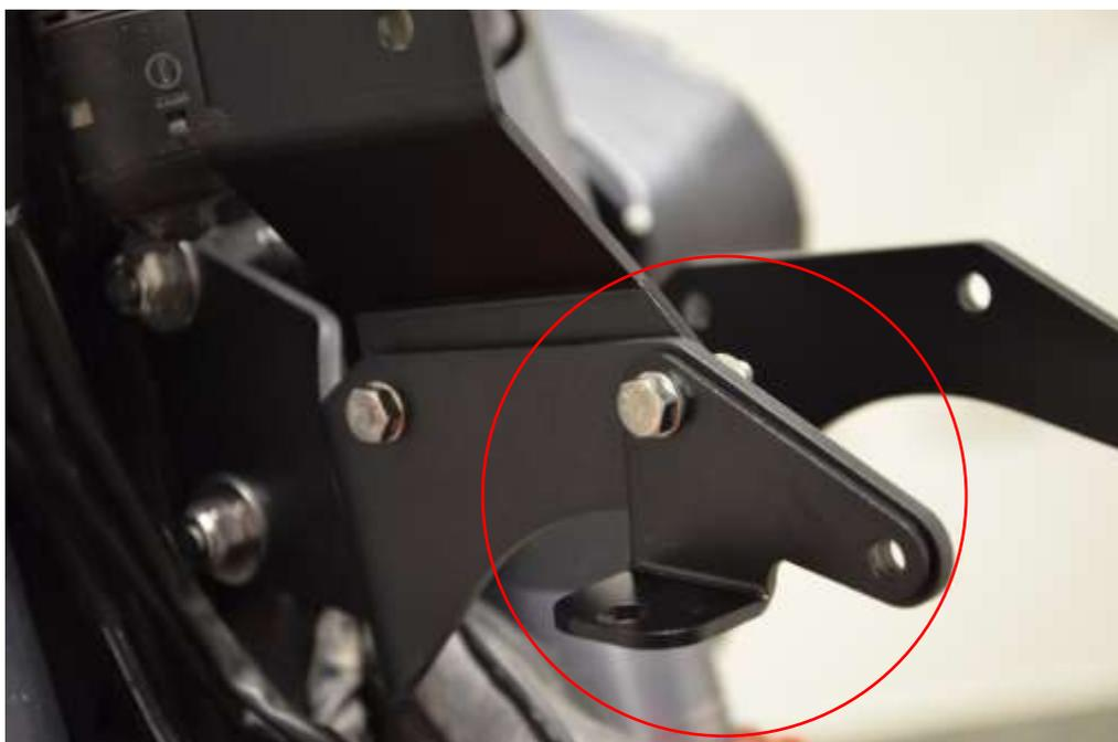
Maintenant, faites de même sur le côté gauche. Utilisez les autres vis M6x25mm et effectuez un léger serrage pour maintenir le composant en place. Vous fixerez la position correcte en assemblant le capot arrière à l'étape suivante.
