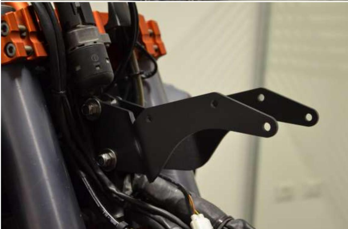
Assemblez la partie latérale droite sur le support nouvellement monté. C'est le seul composant qui nécessite 2 vis M6x25mm montées sur la base (dans le Kit il y en a 4, 2 à droite et 2 à gauche). Ne serrez pas les vis mais laissez le composant libre de bouger. Vous fixerez la position correcte en assemblant le capot arrière à l'étape suivante.
