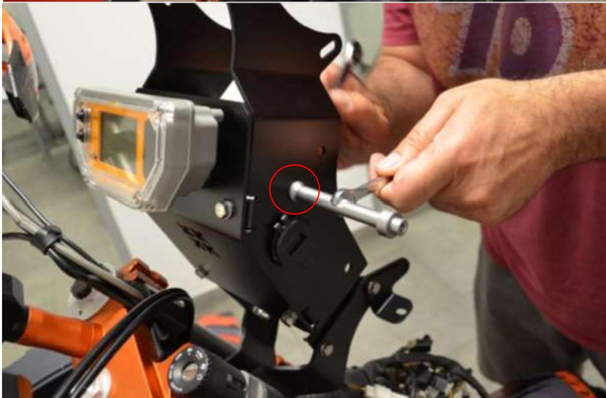
Placez le tube de support de navigation avec les 2 entretoises en plastique orange que vous trouverez dans le kit. Serrez les vis à 10Nm
