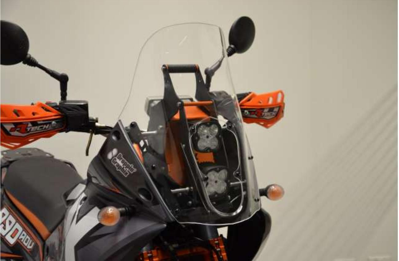
***\* Le kit comprend un tube en carbone robuste de 22 mm de diamètre pour fixer les supports de navigation les plus courants et tous les accessoires 4K du catalogue. Séparément, cependant, vous pouvez également acheter le support rigide réglable à 6 positions compatible avec les normes Garmin et les accessoires de navigation 4K bien sûr!***
