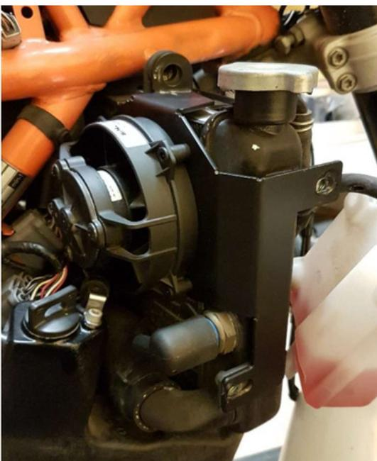
Branchez le ventilateur, remettez le faisceau proprement contre le cadre, et positionnez le ventilateur avec son support à sa place, contre le radiateur.
