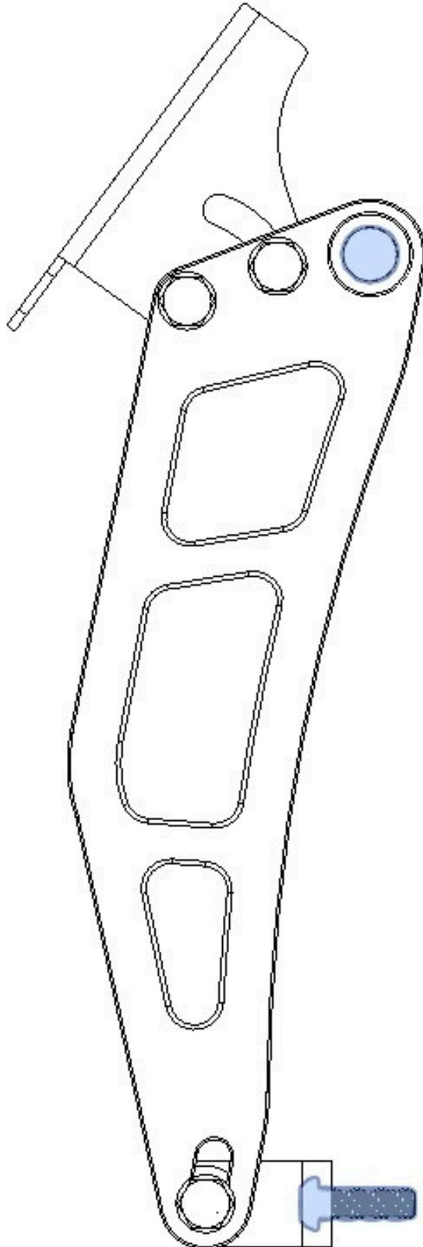
Position de montage des caoutchoucs de 6mm
