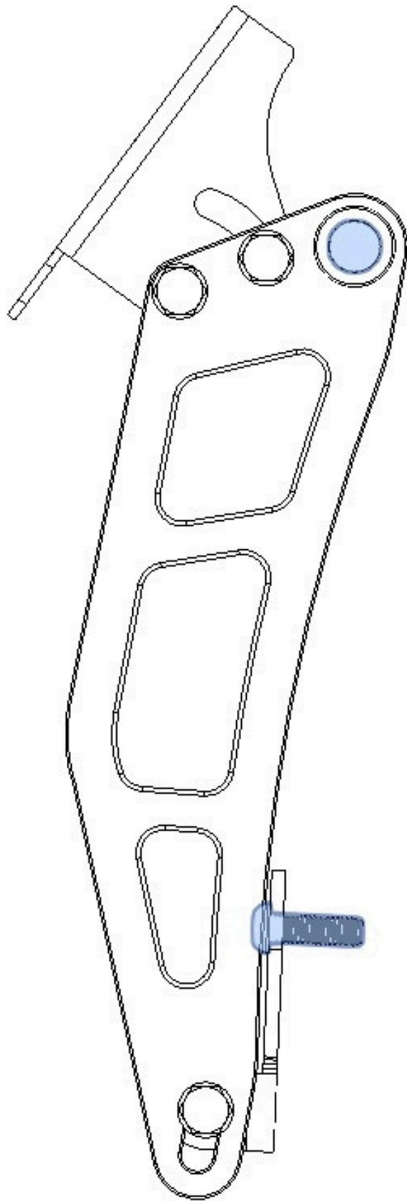
Le kit rally est monté en utilisant les fixations inférieures du phare, et la barre d'instruments de navigation d'origine de la moto. (en bleu, les pièces d'origine à réutiliser)
