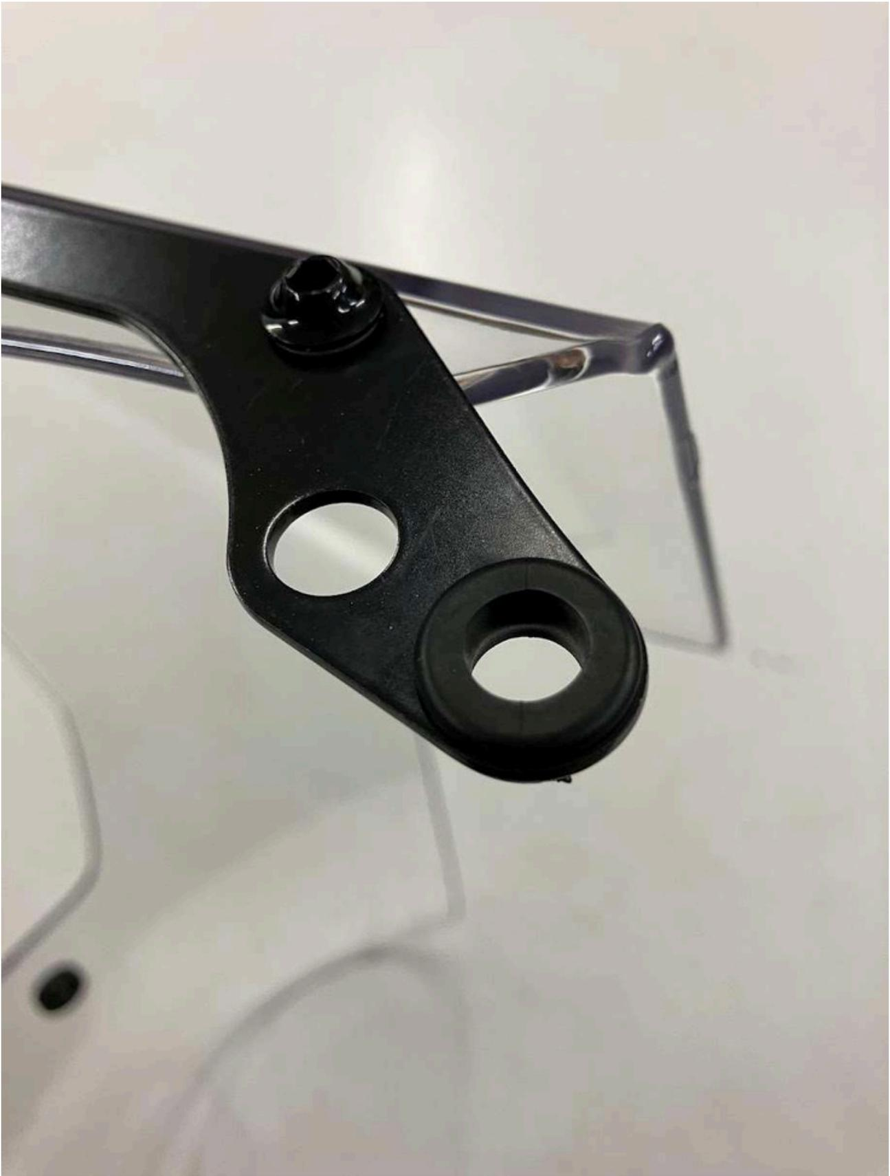
Installez les supports ajustables qui permettent de monter la bulle sur les kits rally EVO.
