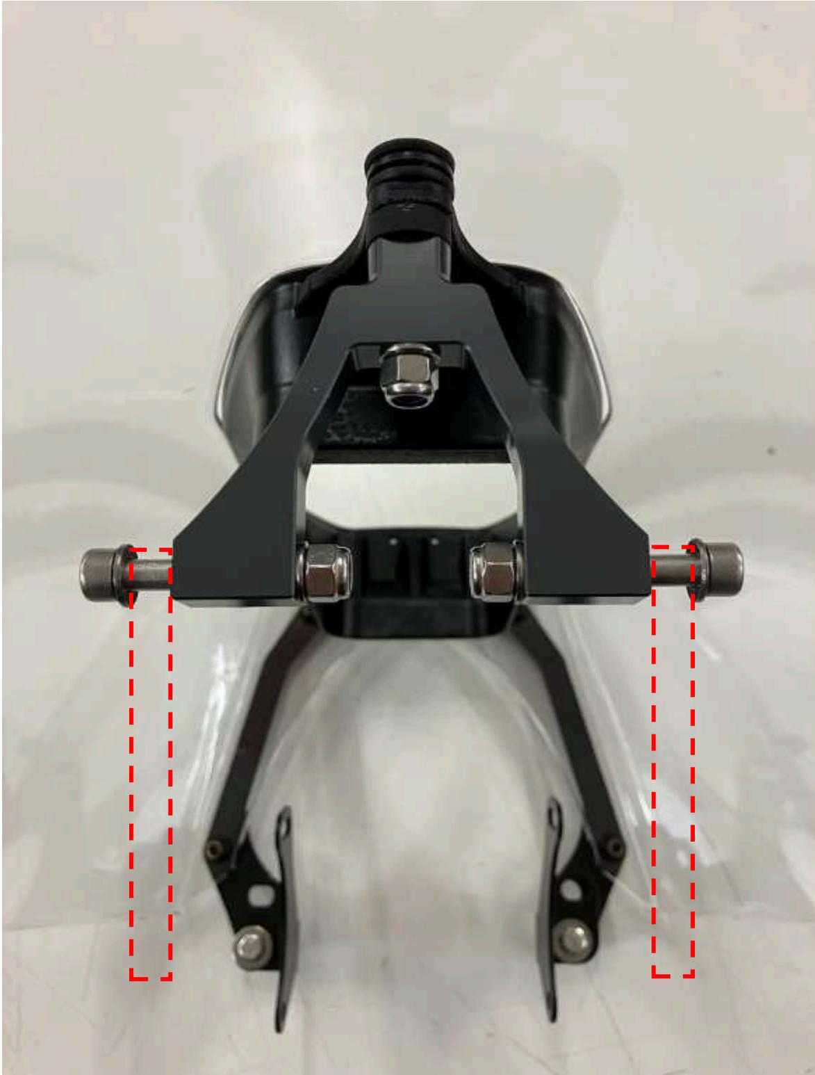
Installez la plaque de protection de feux en la fixant avec les 8 vis auto-foreuses fournies.
