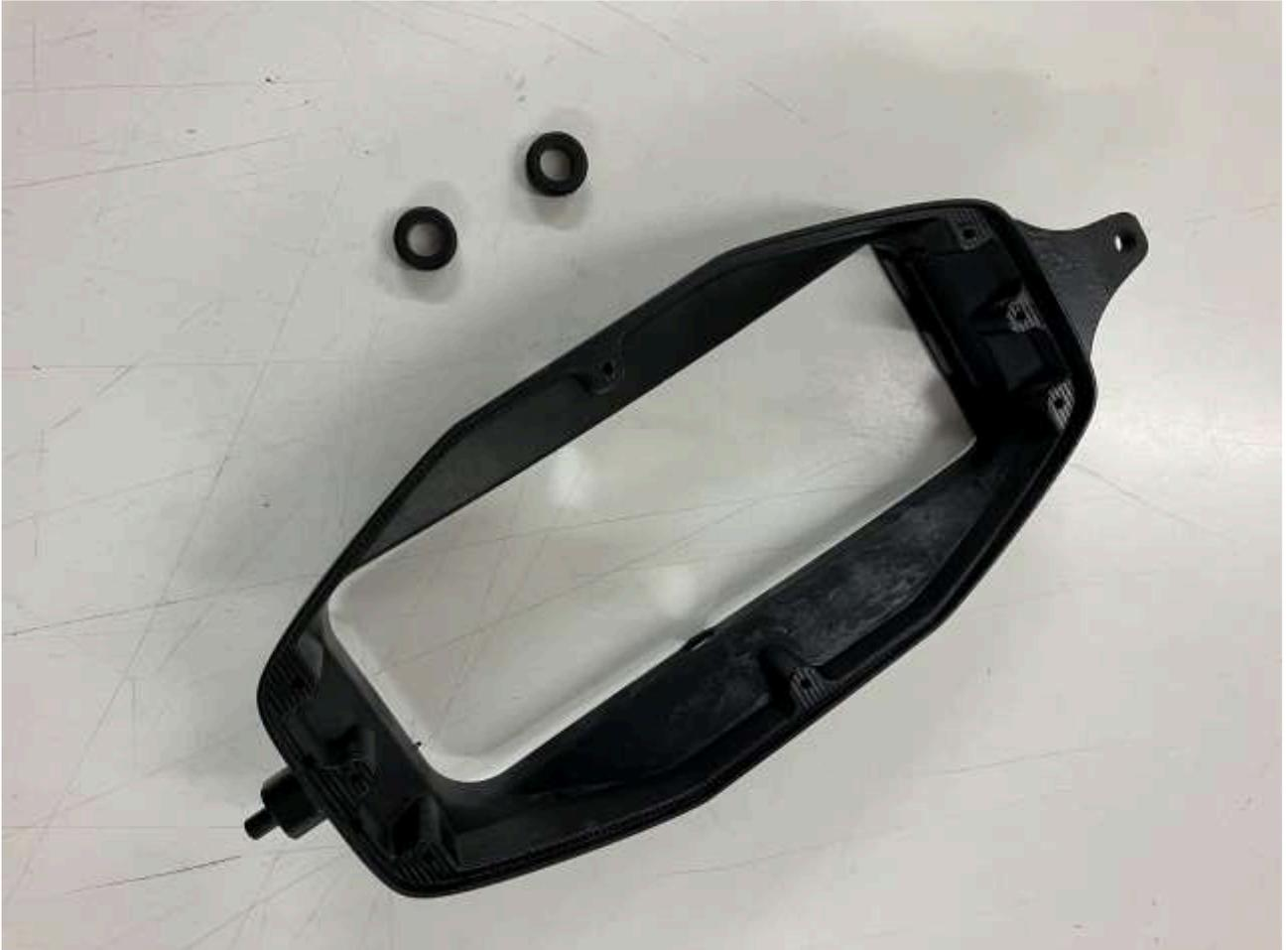
Installez les caoutchoucs de 2mm d'épaisseur sur les trous du masque de feux, ils serviront de silent-blocs une fois inséré dans le kit rally.
