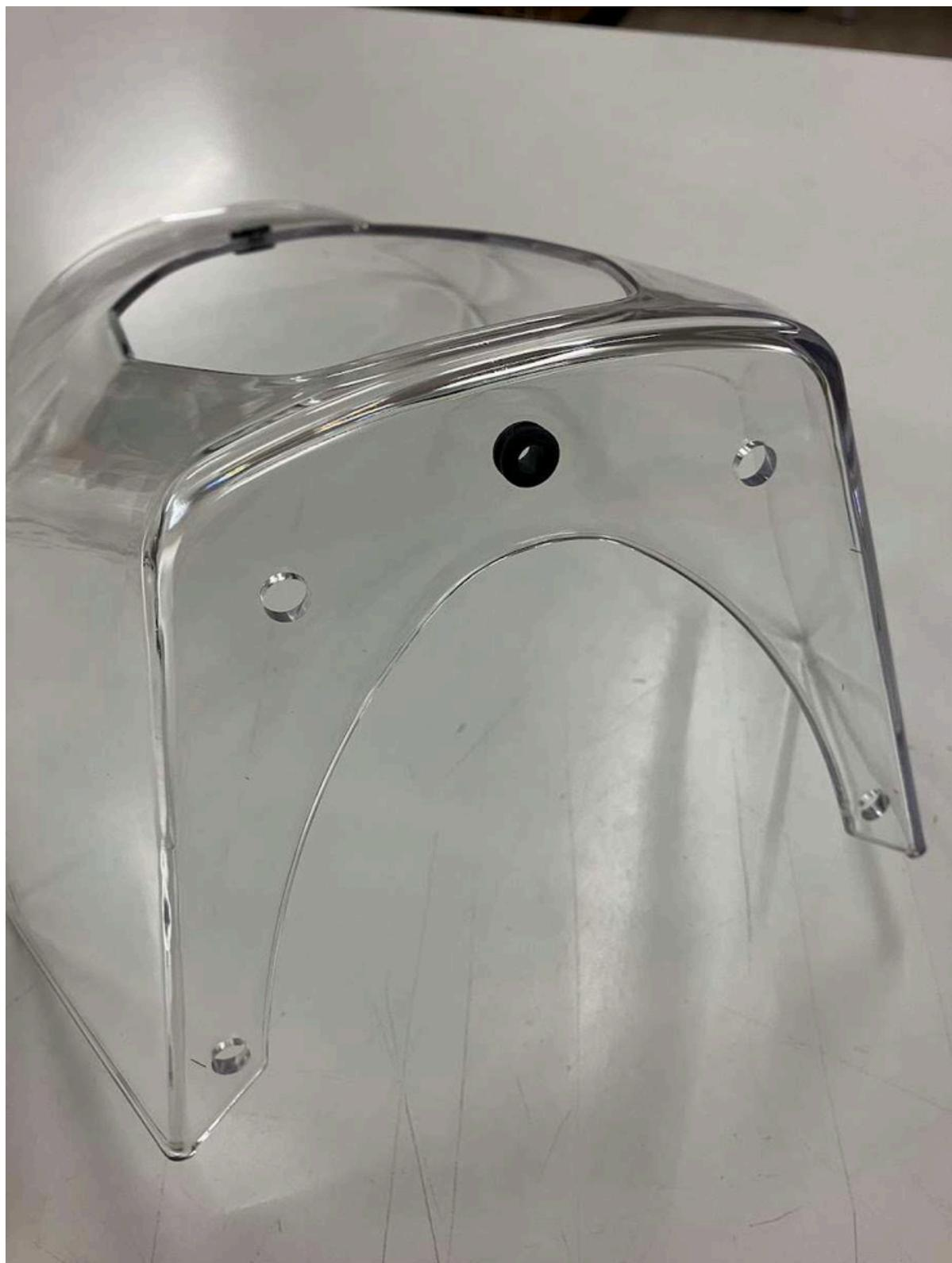
Insérez les caoutchoucs filetés dans les 4 trous inférieurs de la bulle, en les passant de l'intérieur vers l'extérieur.
