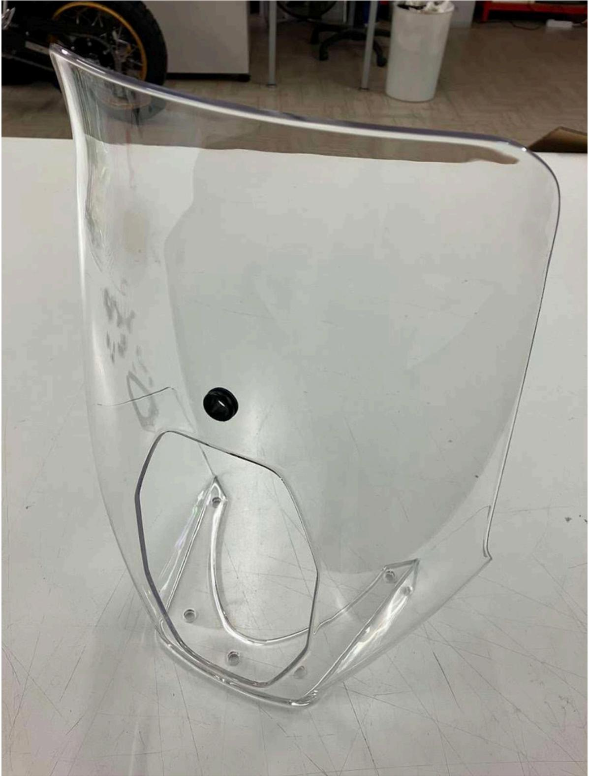
Insérez le caoutchouc de 4mm d'épaisseur pour la vis M5 dans le trou inférieur de la bulle.
