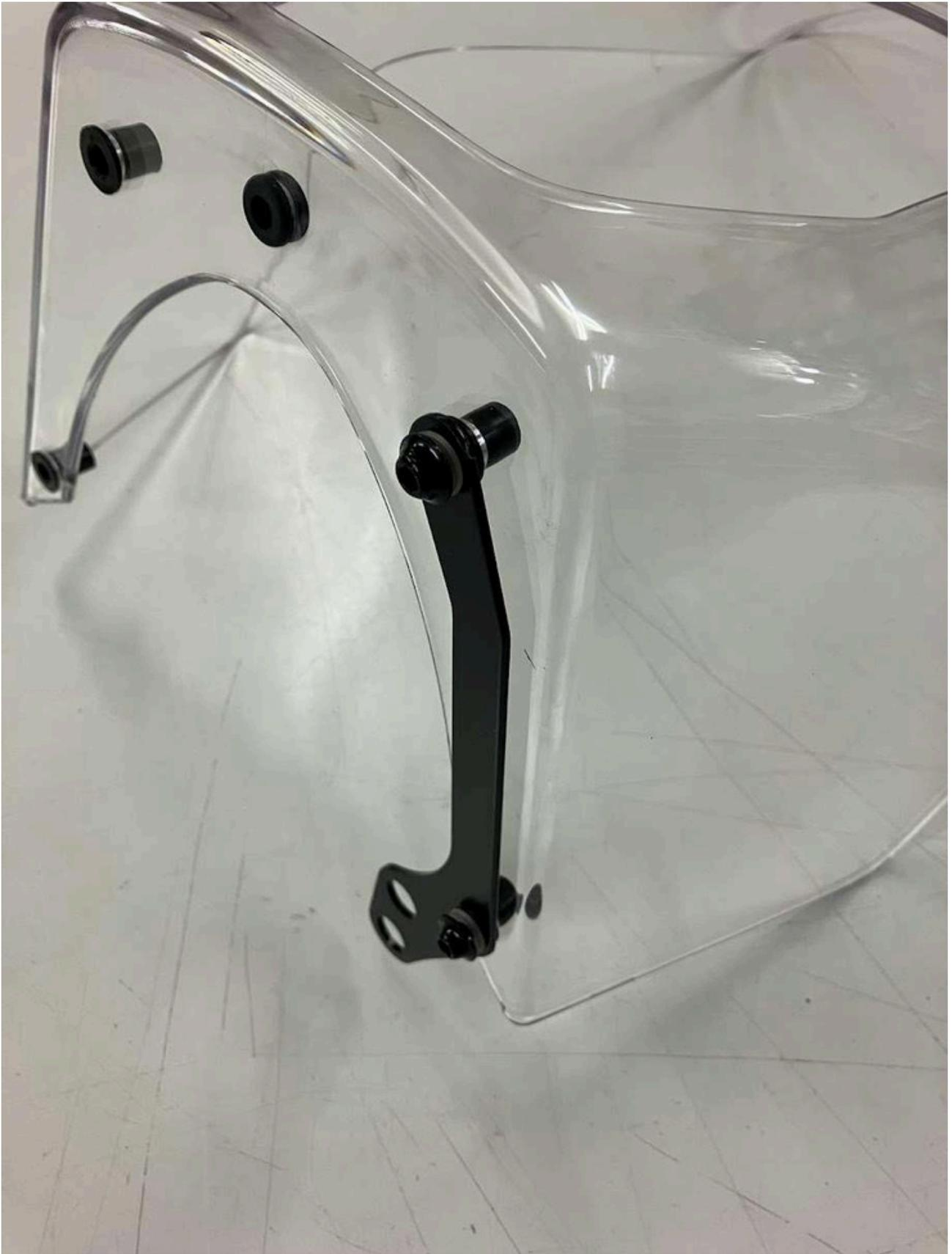
Le caoutchouc fileté doit ressembler à celui sur la photo une fois vissé.
