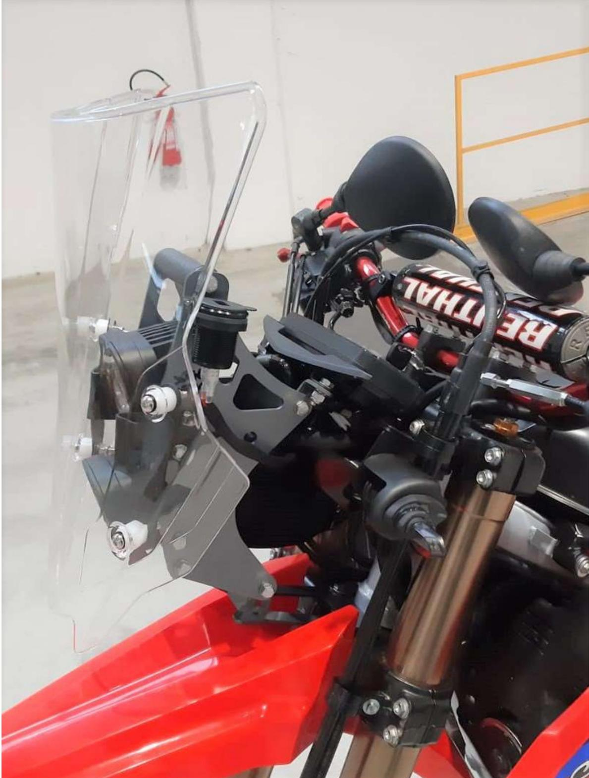
Pour tous nos modèles, nous fournissons le guide câble nécessaire pour le passage de la durit de frein. Il est nécessaire de l'installer pour éviter tout pincement. Le guide câble est imprimé en 3D, résistant au frottement sans causer de dommage à la durit. En cas de dommages causés au guide câble, il est possible de le commander en pièce détachée.
